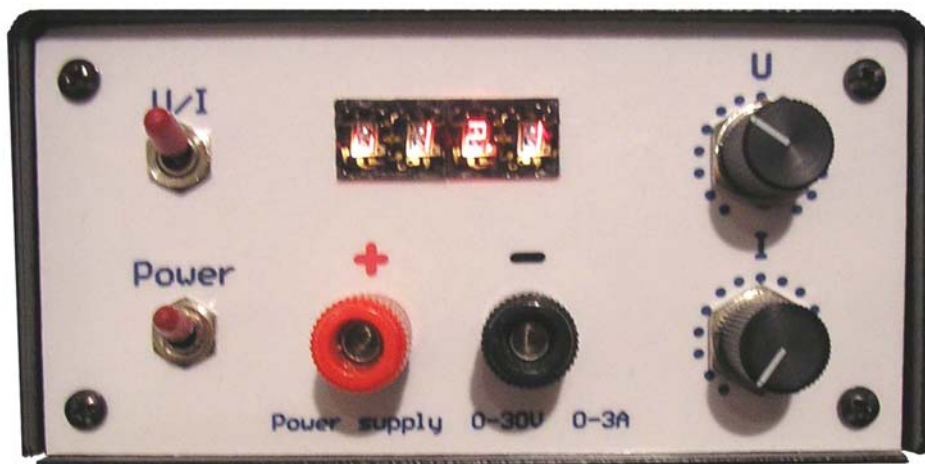
Slika 12 - Čelna plošča napajalnika. Velikost (120 x 60) mm.
